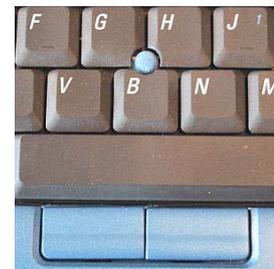
In die Tastatur eines Laptops integrierter Stick, zugehörige Tasten unter der Leertaste
