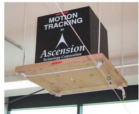
Elektromagnetisches Tracking-System „Flock of Birds“ der Ascension Technology Corp. zur Auswertung der Position und Lage der Sensoren an Datenhelm und Datenhandschuhen
